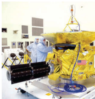
Космический аппарат «Нью Хорайзонс». Хорошо виден РИТЭГ
